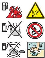
La benzina è altamente infiammabile. Ri-fornire a motore spento in una zona piana e ben ventilata. Non rifornire in presenza di fiamme libere. Evitare di rovesciare il combustibile.
