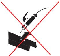
All'avviamento del generatore il circuito di saldatura è immediatamente operativo, cioè sotto tensione.
