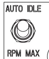
La funzione Autoidle, disponibile solo con il pannello di controllo EVO INSTRUMENT, è abilitata posizionando il selettore in posizione AUTOIDLE.
