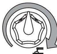
La corrente di saldatura viene regolata dalla manopola (T) in modo continuo, se posta al minimo (completamente ruotata in senso antiorario) la corrente d'uscita è circa 20A, se posta al massimo (completamente ruotata in senso orario) la corrente è regolata al suo valore massimo.
