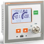
L'avviamento e l'arresto del motore si effettuano agendo direttamente sulla centralina di comando e controllo **RGK420SA**.
