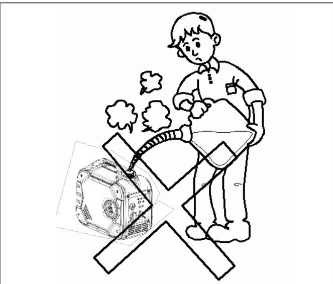
Fermare il motore prima del rifornimento
