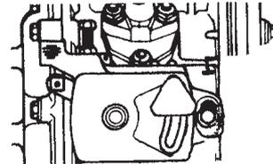
Per fermare il motore in una condizione di emergenza azionare immediatamente la leva stop (28)
