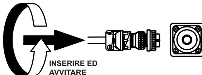
La saldatrice è predisposta per la connessione ad un comando a distanza (opzionale) tramite il connettore circolare posto sul frontalino. Una volta effettuata la connessione al comando a distanza, la funzione di regolazione del potenziometro principale, posto sul frontalino, viene automaticamente commutata sul potenziometro del comando a distanza.
