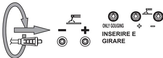
Inserire a fondo le spine dei cavi di saldatura nelle prese (scriccatura, "only gauging", 9+/10-) ruotando in senso orario per bloccarle. Assicurarsi che la pinza di massa, il cui cavo va collegato alla presa - o a quella +, secondo il tipo d'elettrodo, faccia un buon contatto e che sia, possibilmente, vicina alla posizione di saldatura. Portare attenzione alle due polarità, del circuito di saldatura, le quali non devono venire a contatto elettrico tra loro.
