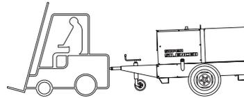
Ad ogni spostamento verificare che il motore sia spento, che non vi siano collegamenti con cavi che impediscano detto spostamento.
