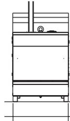
E' buona norma fissare la macchina a piazzole di sufficiente rigidità, isolate contro le vibrazioni verso altre strutture, e con una massa pari ad almeno tre volte il peso della macchina, questo garantisce un adeguato assorbimento delle vibrazioni prodotte dalla macchina.
