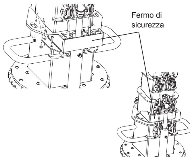
Il fermo arresta la discesa del palo ad un'altezza di sicurezza che evita il rischio di urti con i proiettori durante la normale fase discesa o in caso di rottura improvvisa delle funi del palo telescopico o del sistema idraulico di sollevamento.
