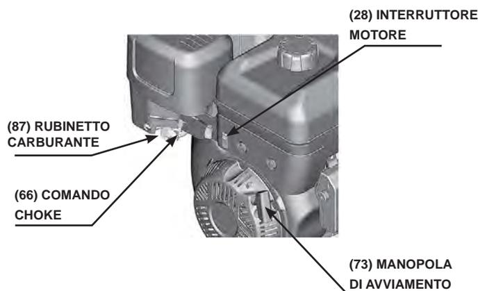
**N.B.:** Non utilizzare la valvola dell'aria se il motore è caldo o la temperatura dell'aria è elevata.
