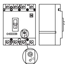
Nei modelli con correnti di intervento regolabile **non modificare** le tarature in quanto si potrebbe compromettere la protezione dell'impianto o le caratteristiche d'uscita del gruppo elettrogeno. Per eventuali variazioni interpellare il nostro Servizio di Assistenza Tecnica.
