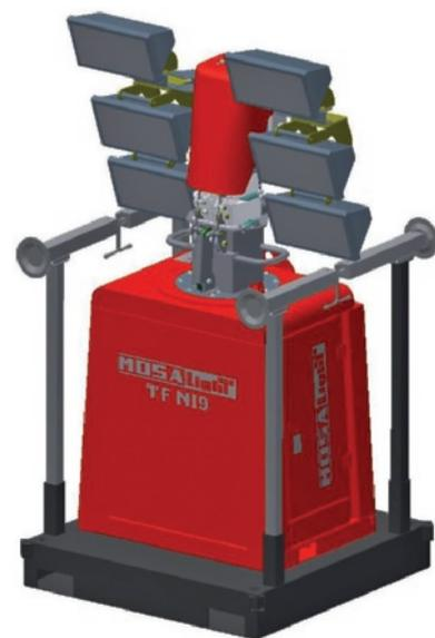
**Mosa sta lavorando su una nuova tipologia di torre faro molto compatta e allestita su un basamento con stabilizzatori per essere posizionata direttamente al suolo oppure, togliendo basamento e stabilizzatori, su un carrello stradale. Verrà alimentata mediante un gruppo elettrogeno generico o direttamente dalla rete elettrica. Con un'altezza di 9 m, utilizzerà 6 lampade alogene.**
