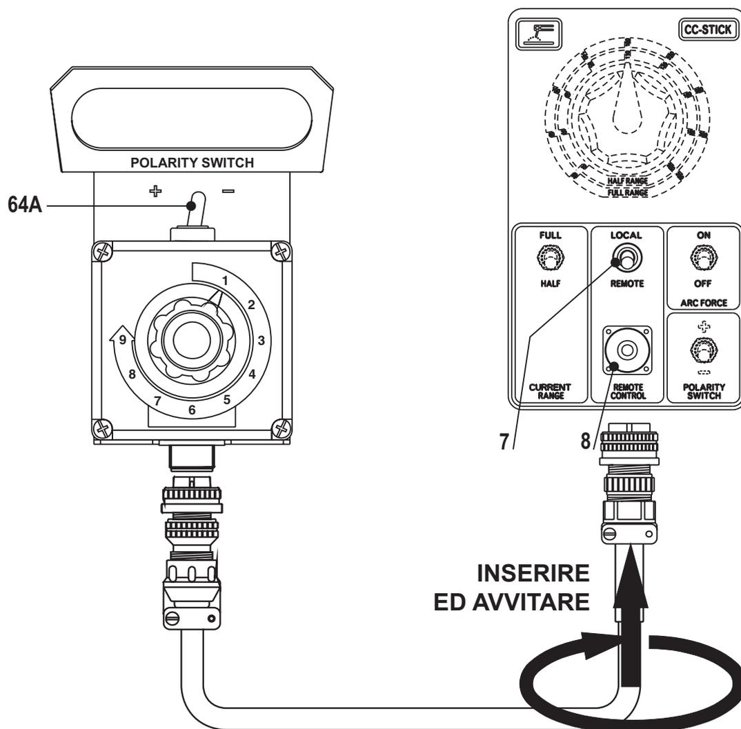
Il comando, per regolare a distanza la corrente di saldatura, viene collegato al pannello frontale con un connettore multiplo.
