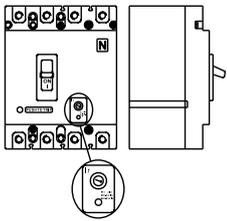
Il gruppo elettrogeno è protetto contro i corto circuiti e contro i sovraccarichi da un interruttore magnetotermico (Z2) posto a monte dell'impianto. Le correnti d'intervento sia termiche che magnetiche possono essere fisse o regolabili in funzione del modello di interruttore.
