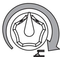
Posizionare la manopola del regolatore corrente di saldatura (T) in corrispondenza del valore di corrente prescelto in modo da ottenere l'ampereaggio necessario, tenendo presente il diametro ed il tipo d'elettrodo. Per i dati tecnici vedere pag. M1.6
