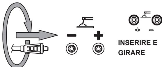
Assicurarsi che la pinza di massa, il cui cavo va collegato alla presa - o a quella +, secondo il tipo d'elettrodo, faccia un buon contatto e che sia, possibilmente, vicina alla posizione di saldatura.
