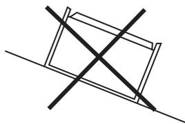
Posizionare sempre la macchina su una superficie piana e solida che non sia soggetta a cedimenti in modo da evitare ribaltamenti, slittamenti o cadute durante il funzionamento.
