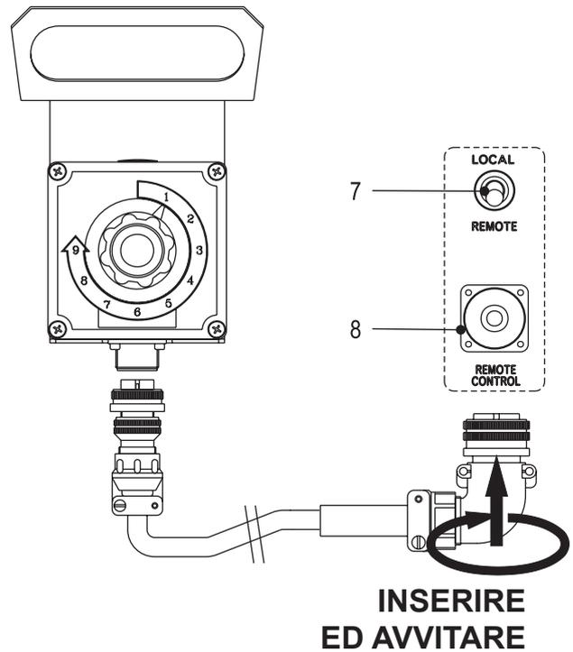
Il comando, per regolare a distanza la corrente di saldatura, viene collegato al pannello frontale con un connettore multiplo.
