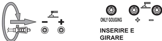
Assicurarsi che la pinza di massa, il cui cavo va collegato alla presa - o a quella +, secondo il tipo d'elettrodo, faccia un buon contatto e che sia, possibilmente, vicina alla posizione di saldatura.
