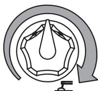
Posizionare la manopola (T) in corrispondenza del valore di corrente prescelto in modo da ottenere l'ampereaggio necessario, tenendo presente il diametro ed il tipo d'elettrodo. Per i dati tecnici vedere pag. M1.6
