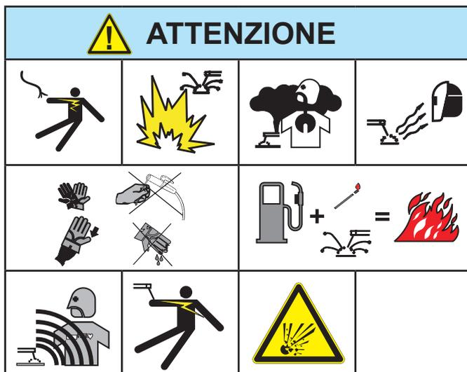
Assicurarsi che l'area sia sicura prima di effettuare qualsiasi operazione di saldatura.
