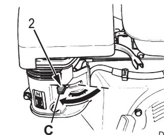
3 - Ruotare l'interruttore (3) del motore in posizione ON.
