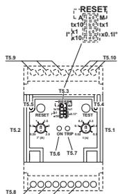
Avant chaque séance de travail vérifier le fonctionnement du dispositif de protection différentiel en appuyant sur la touche d'essai. Le groupe électrogène doit être en marche et le levier de l'interrupteur différentiel en position ON.
