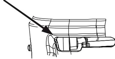
**N.B.:** Ne pas utiliser la soupape de l'air si le moteur est chaud ou la température de l'air élevée.
