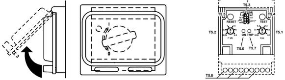
Avant chaque séance de travail vérifier le fonctionnement du dispositif de protection différentiel en appuyant sur la touche d'essai. Le groupe électrogène doit être en marche et le levier de l'interrupteur différentiel en position ON.
