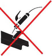
Lors du démarrage du générateur, le circuit de soudure est immédiatement opérationnel, c'est-à-dire sous tension. Vérifier l'absence de tout contact électrique inapproprié entre les divers éléments du circuit extérieur de soudure (électrode, pince porte-électrode, pièce de travail, etc...).
