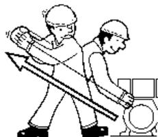
6) Tirer fermement la corde aussi loin qu'elle va. Si c'est nécessaire, utiliser deux mains
