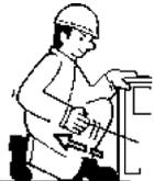
4) Tirer la corde de démarrage jusqu'à ce que vous sentiez de la résistance et la laisser retourner lentement à sa position d'origine
