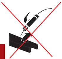
Beim Anlassen des Generators ist der Schweißstromkreis sofort betriebsbereit, d.h. unter Spannung. Sicherstellen, dass keine unerwunschten Kontakte zwischen den Komponenten des aueren Schweißstromkreises entstehen (Elektroden, Elektrodenhalter- Zange, Schweißstuck etc.).
