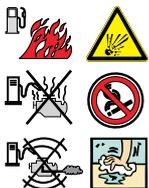
Das Benzin ist hoch entflammbar. Bei abgeschaltetem Motor auf einer ebenen und gut belüfteten Fläche Benzin auffüllen. Tank nicht bei Vorhandensein von offenen Flammen füllen. Keinen Kraftstoff verschütten. Kraftstoffdämpfe und -reste sind entflammbar. Evtl. verschütteter Kraftstoff ist vor dem Starten des Motors sorgfältig zu entfernen.
