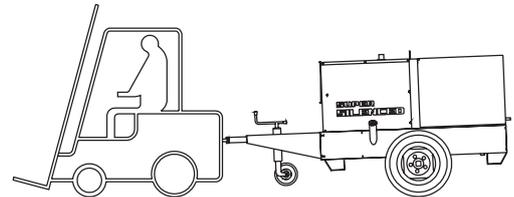
Die Fahrgestelle sind ausschließlich zum Bewegen der Stromerzeuger zu verwenden, für die sie bemessen wurden.
