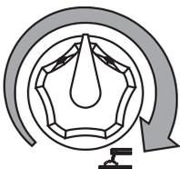
Den Schalter Schweißstromregler (T) entsprechend dem gewählten Schweißstrom einstellen, um die notwendige Amperezahl zu erhalten. Dabei ist der Elektrotyp und der Durchmesser zu berücksichtigen. Technische Daten Siehe Seite M1.6.
