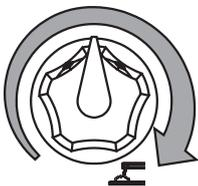
Den Schalter Schweißstrom- regler (T) entsprechend dem gewählten Schweißstrom einstellen, um die notwendige Amperezahl zu erhalten, abhängig von den benutzten Elektroden (Typ und Durchmesser).
