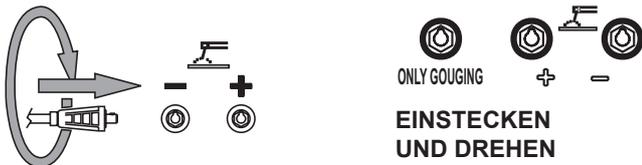
Sicherstellen, daß die Massezange, deren Kabel an die Steckdose - oder an +, je nach Elektrodentyp, einen guten Kontakt hat und möglichst nahe an der Schweißposition ist. Besonders Achtung gilt den beiden Polaritäten die nicht miteinander in elektrischen Kontakt kommen dürfen. Bei Verwendung zum Fugenhobeln - wenn eingebaut- die Massezange an die Steckdose-anschießen, die andere an die Steckdose "only gouging"
