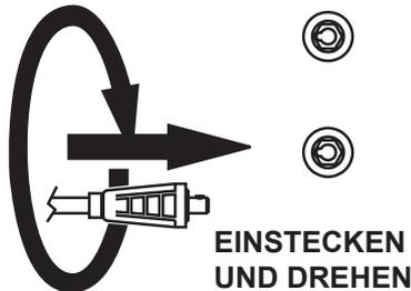
Die Massezange an die Negativbuchse anschließen und das Elektrodenhalterkabel an die Positivbuchse.
