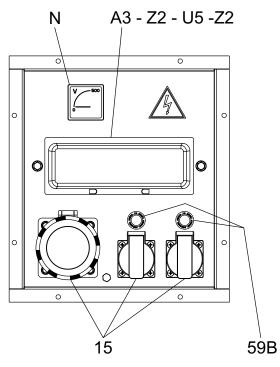
400/230x2 (Schuko) Versione con Sorvegliatore d'isolamento Isometer version
