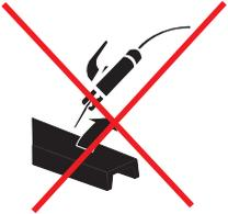
Beim Anlassen des Generators ist der Schweistromkreis sofort betriebsbereit, d.h. unter Spannung. Sicherstellen, dass keine unerwnschten Kontakte zwischen den Komponenten des aueren Schweistromkreises entstehen (Elektroden, Elektrodenhalter- Zange, Schweistuck etc.).
