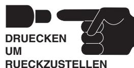
Den Knopf nicht gedrückt halten. Im Falle eines weiterhin bestehenden Fehlers kann der Thermoschutz nicht auslösen und damit kann das Aggregat, **beschädigt** werden.
